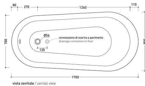
Capacità Max / Max Capacity 165 L.
